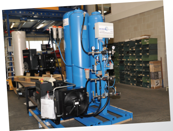
Elk apparaat is modulair, te vervoeren met een heftruck en past in een container.
